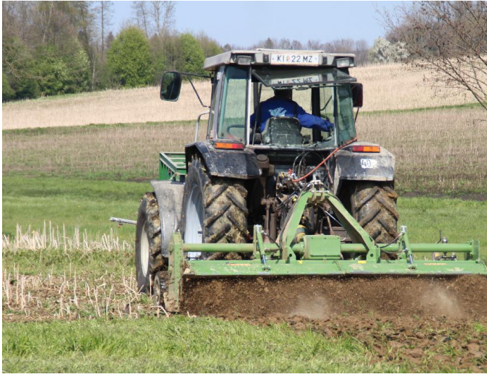
Abbildung 12: Mit der Bodenfräse wurde eine flächige Bearbeitung erreicht. Mittels Kreiselegge konnte dann die Saatbettbereitung für den Mais durchgeführt werden.
