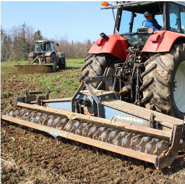
Abbildung 10: Mit der Kreiselegge wurde keine flächige Bearbeitung erreicht.
