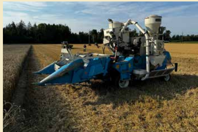
Abb. 3: Bei der Ernte der Versuchsvarianten war ein Parzellenmähdrescher im Einsatz. LK OÖ/KASTENHUBER
