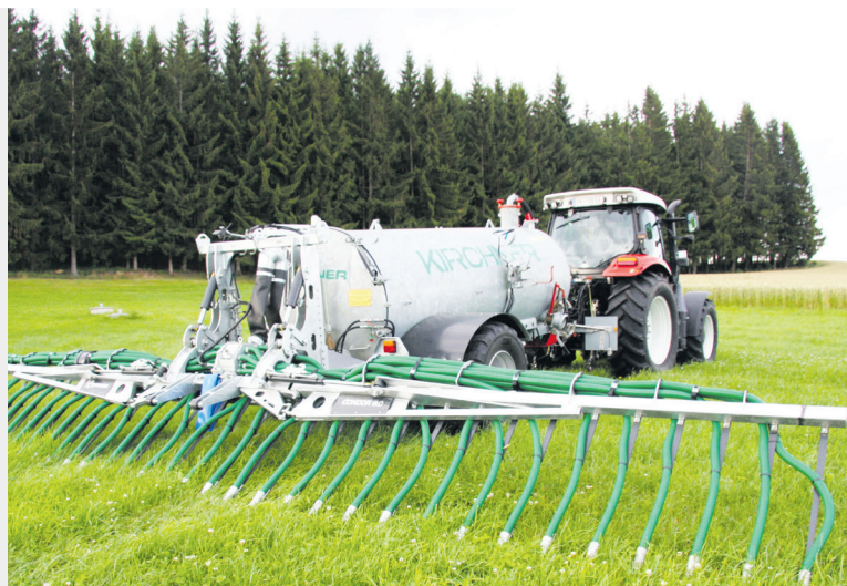
Die Gülleausbringung mittels Schleppschuh reduziert die Stickstoffverluste um ca. 50 Prozent.
