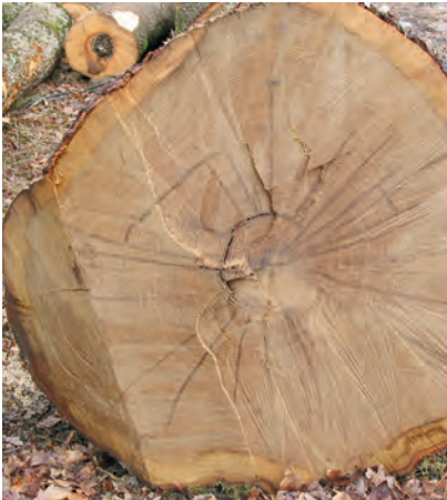
Spinnerin (Eiskluft) und Ringschäle bei Eiche
