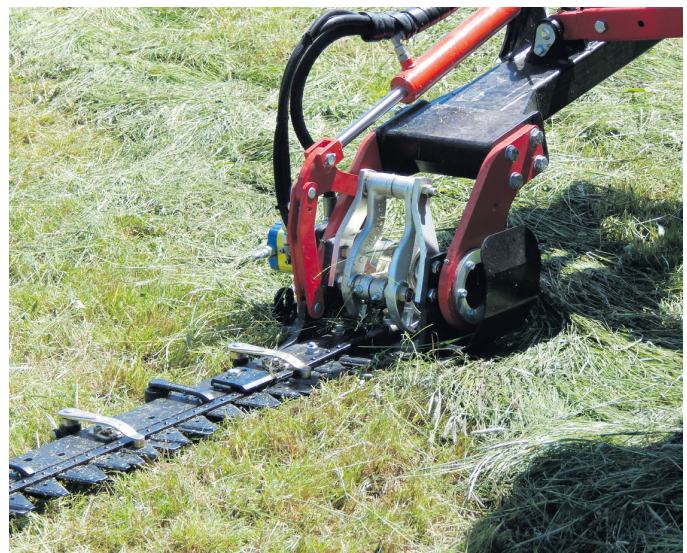
Am insektenschonendsten – das Doppelmessermähwerk.
