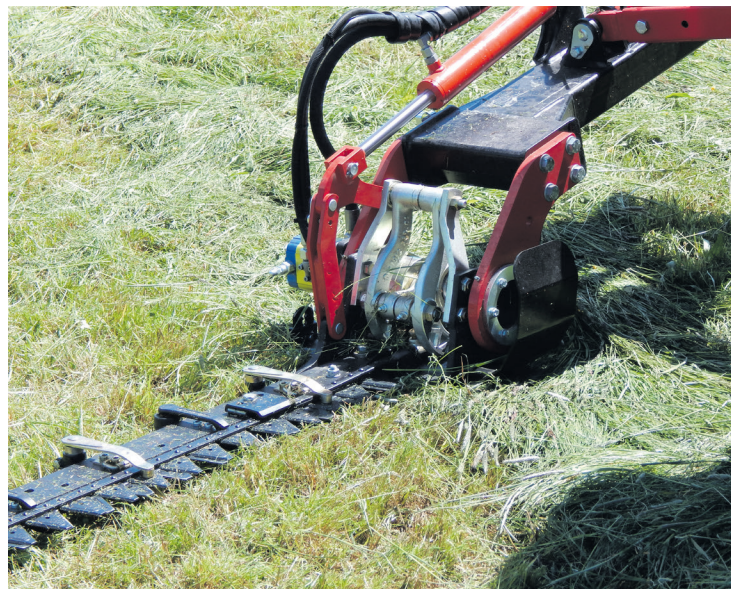
Am insektenschonendsten – das Doppelmessermähwerk.
