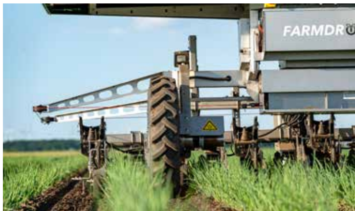
Mit modernen Positionierungssystemen & Sensorik wird punktgenau Saatgut ausgebracht oder genau zwischen den Pflanzen gehackt. Foto: agrarfoto
