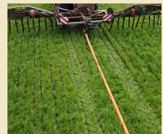
Abb. 1: Bei der Gülleausbringung mittels Schleppschlauch werden die Ammoniakemissionen um ca. 30 % reduziert.
