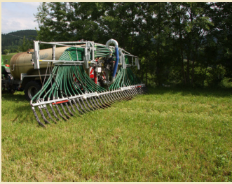
Abb. 4: Bei der Gülleausbringung mittels Schleppschuh werden die Ammoniakemissionen um ca. 50 % reduziert.
