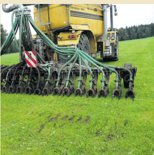
Abb. 5: Bei der Gülleausbringung mittels Gülleinjektion werden die Ammoniakemissionen um ca. 80 % reduziert.
