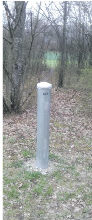
Die Grundwassergüte wird mit Messstellen im Rahmen der Gewässerzustandsüberwachungsverordnung (GZÜV) laufend überwacht. BWSB/Wallner
