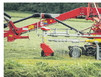
Das Multitast Rad, welches für die meisten Pöttinger Zett- und Schwadkreisel zur Verfügung steht, reduziert den Schmutzeintrag im Futter um bis zu zwei Drittel. FOTO: PÖTTINGER
