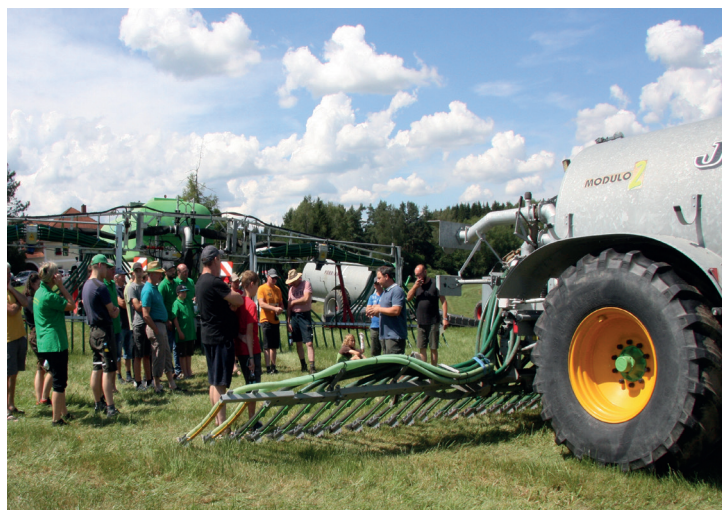
Die bodennah streifenförmige Gülleausbringung hat den größten Effekt, um Ammoniakverluste zu minimieren.
