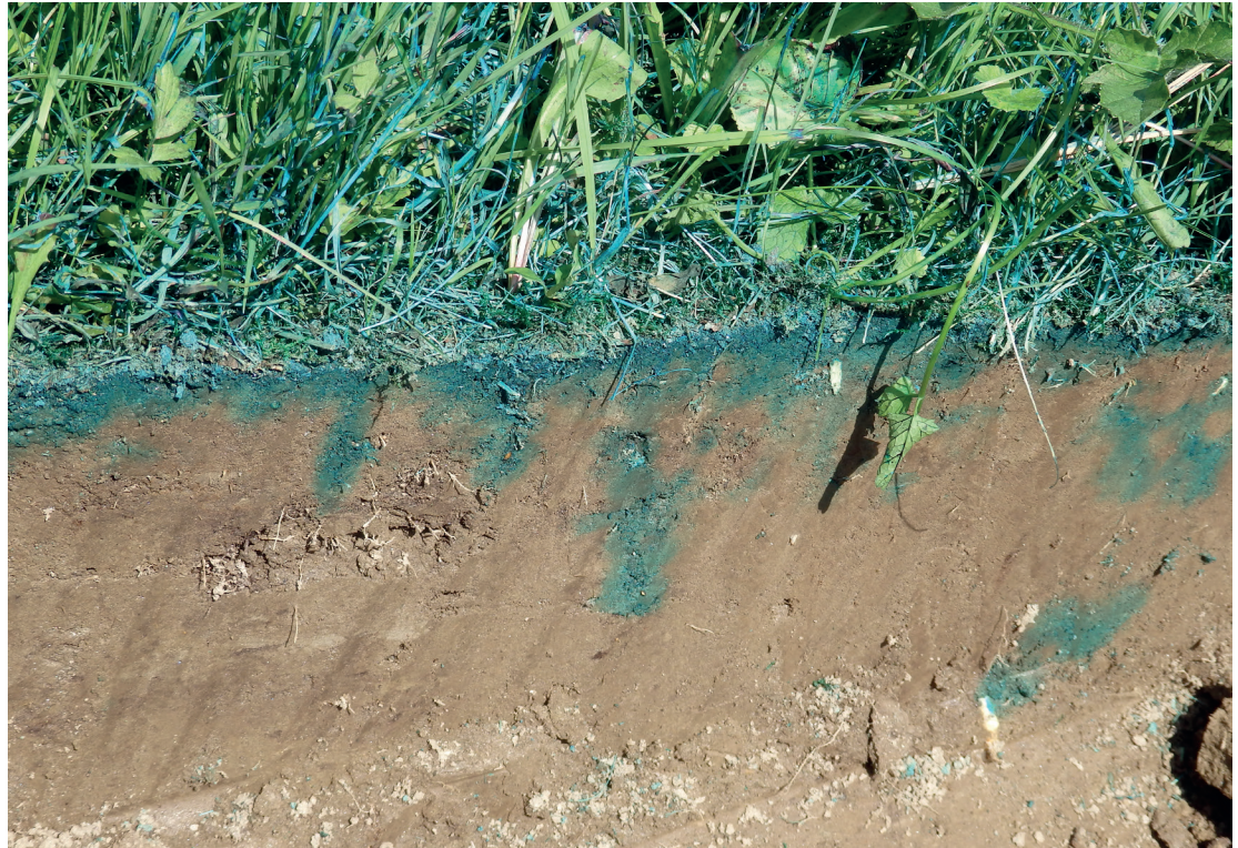
Blau Farbe: Wassergesättigte Zone in der obersten Bodenschicht nach heftigem Regen und bevorzugte Fließbahnen des Sickerwassers im Boden (Wurzelgänge).
