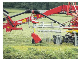
Das Multitast Rad, welches für die meisten Pöttinger Zett- und Schwadkreisel zur Verfügung steht, reduziert den Schmutzeintrag im Futter um bis zu zwei Drittel. FOTO: PÖTTINGER
