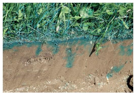
Blaue Farbe: Wassergesättigte Zone in der obersten Bodenschicht nach heftigem Regen und bevorzugte Fließbahnen des Sickerwassers im Boden (Wurzelgänge).
