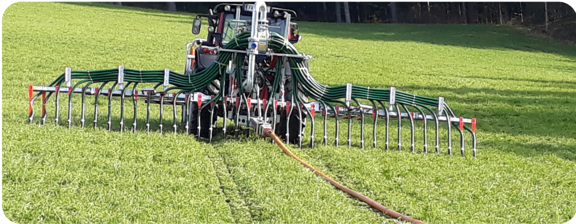
Gülleverschlauchung mit Schleppschuh | BWSB, Franz Xaver Hölzl
