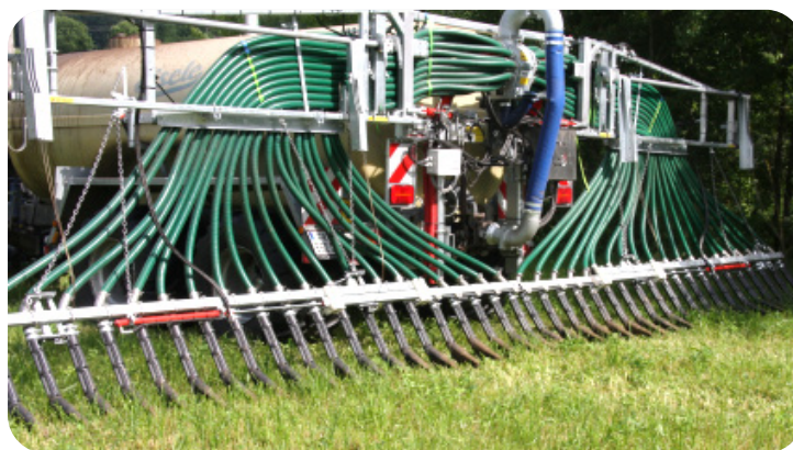
Am Grünland erfolgt die bodennahe streifenförmige Ausbringung von Gülle am häufigsten mittels Schleppschuhtechnik. | BWSB, Franz Xaver Hölzl
