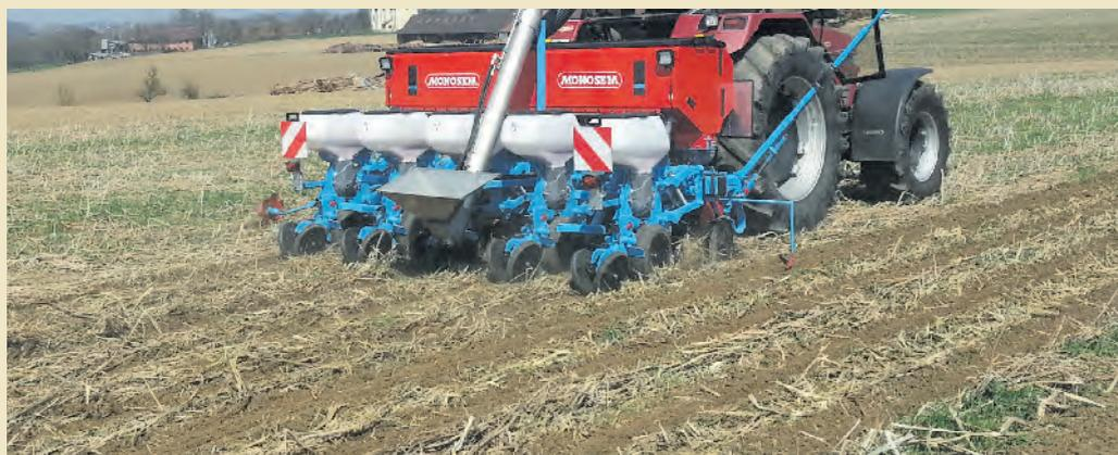
Abbildung 6: Eine passende Bodenbedingung mit der geeigneten Sätechnik ermöglicht die Aussaat direkt in den unbearbeiteten Begrünungsbestand. QUELLE: BWSB
