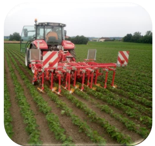
Hacken 2022: Hackgerät, Chopstar mit Kameralenkung und Fingerräder
