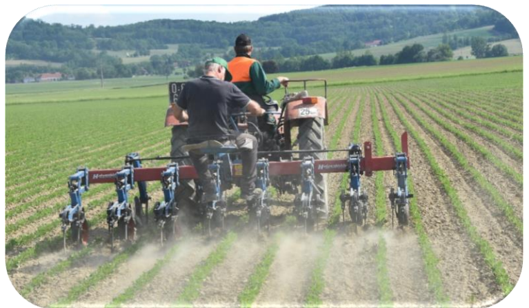
Optimale Bedingungen bei der mechanischen Unkrautregulierung mit einem „alten“ 7-reihigen Rübenhackgerät.
