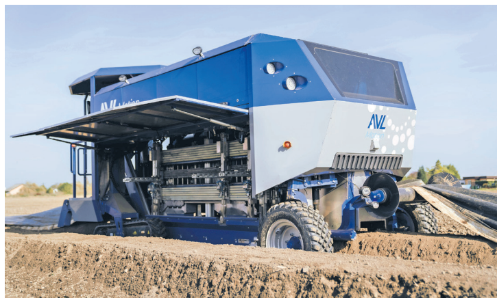
Der Spargelernteroboter „Compact S9000“ soll bis zu 9.000 Spargelstangen pro Stunde ernten können.
