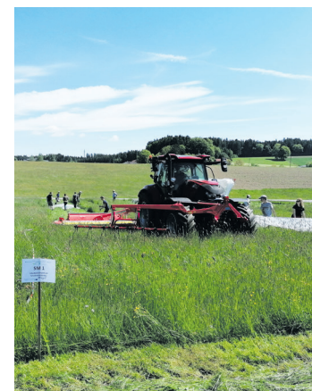
Ein Striegel im Frontanbau soll Insekten zur Flucht anregen. LK OÖ/Fritscher
