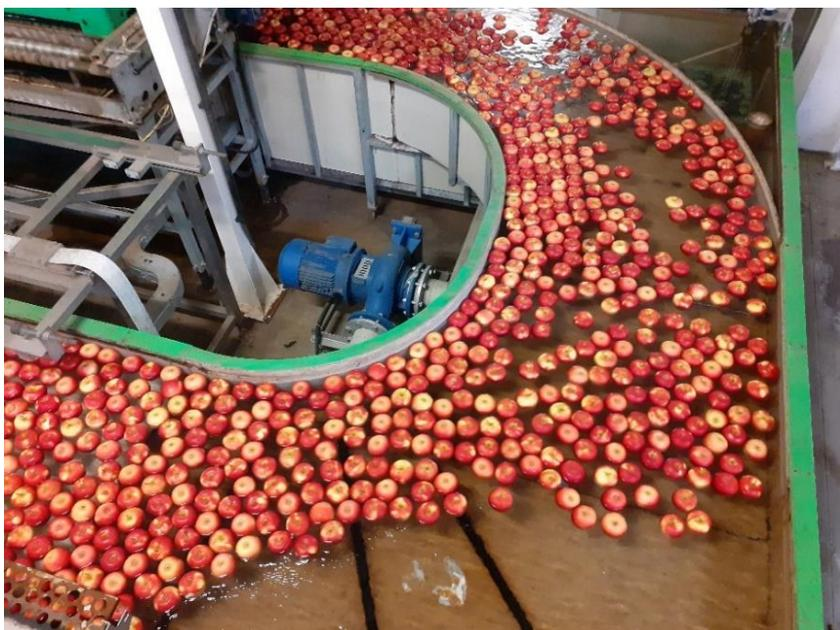
Bildtext: Alles dreht sich um den Apfel. Dieser schwimmt bei der Sortierung im Wasser auf das Lager zu. So werden Druckstellen vermieden.
