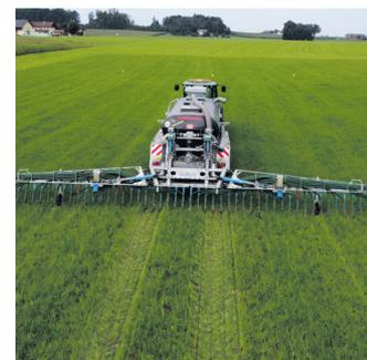
Gülleausbringung mittels Schleppschuh in angewachsene Bestände.
