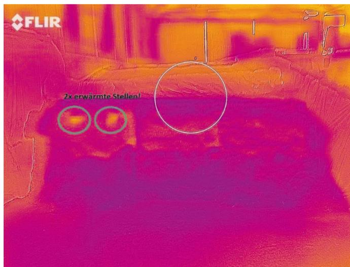
Bereits eine leicht erwärmte Stelle im Silo konnte auf diesem Betrieb mittels Infrarotbild exakt lokalisiert werden. Somit konnten frühzeitig Maßnahmen zur Eindämmung gesetzt werden.
