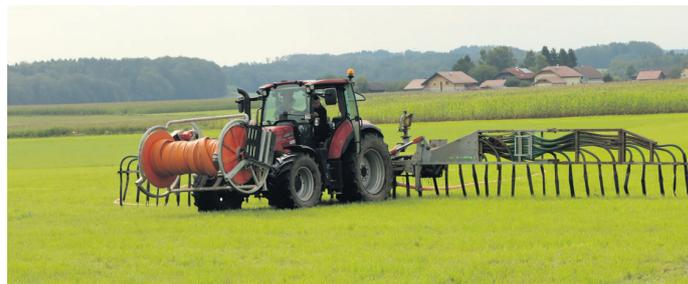
Gülleverschlauchung mit Schleppschlauchverteiler.
