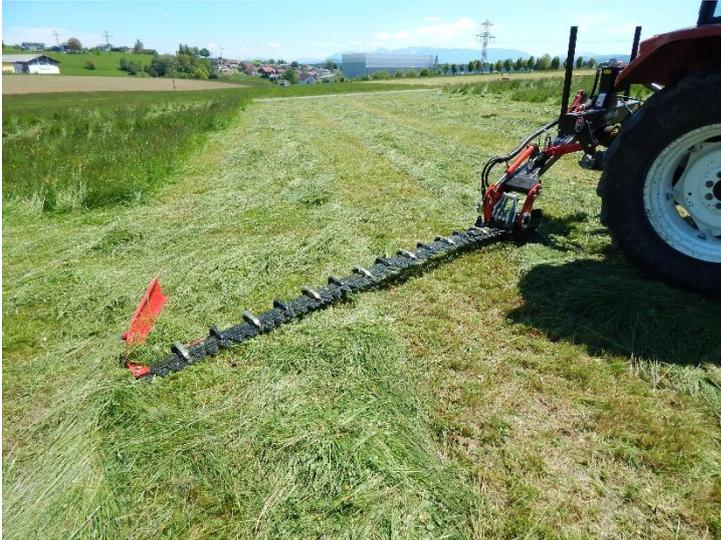
**Bildtext:** Hier wird mit einem Doppelmessermähwerk gemäht. Auch diese Technik wird auf ihr Potenzial zur Insektenschonung untersucht.
