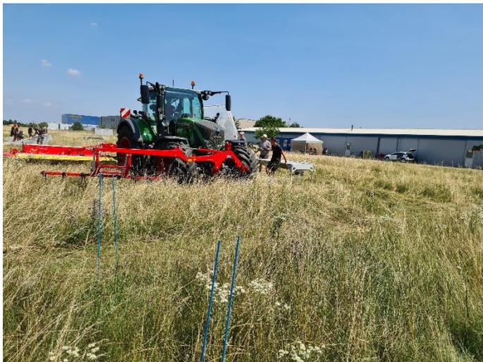
**Bildtext:** Bei diesem Scheibenmähwerk gibt es eine Vorrichtung, um Insekten vor dem Mähen aufscheuchen zu können. Dadurch werden diese geschützt.
