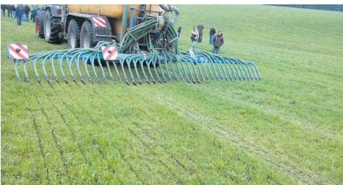
Die bodennahe Gülleausbringung mittels Schleppschuh reduziert die Ammoniakverluste.
