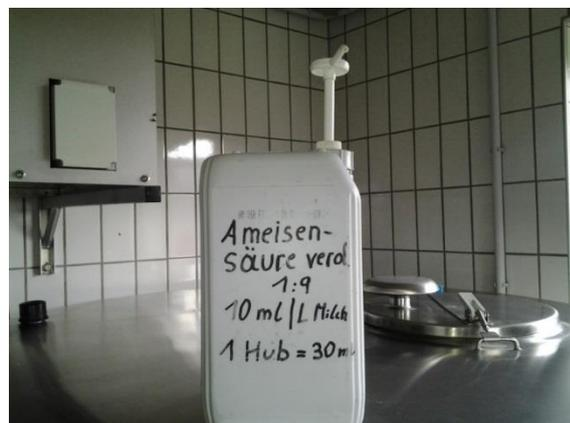
Verdünnte Säure mit Pumpe dosieren.
