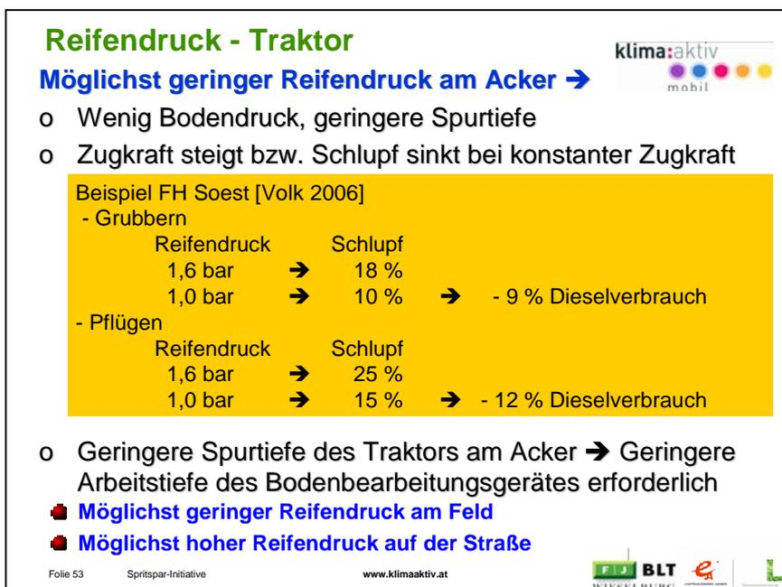
Abbildung 46: Kraftstoffeinsparung mit geändertem Reifendruck
