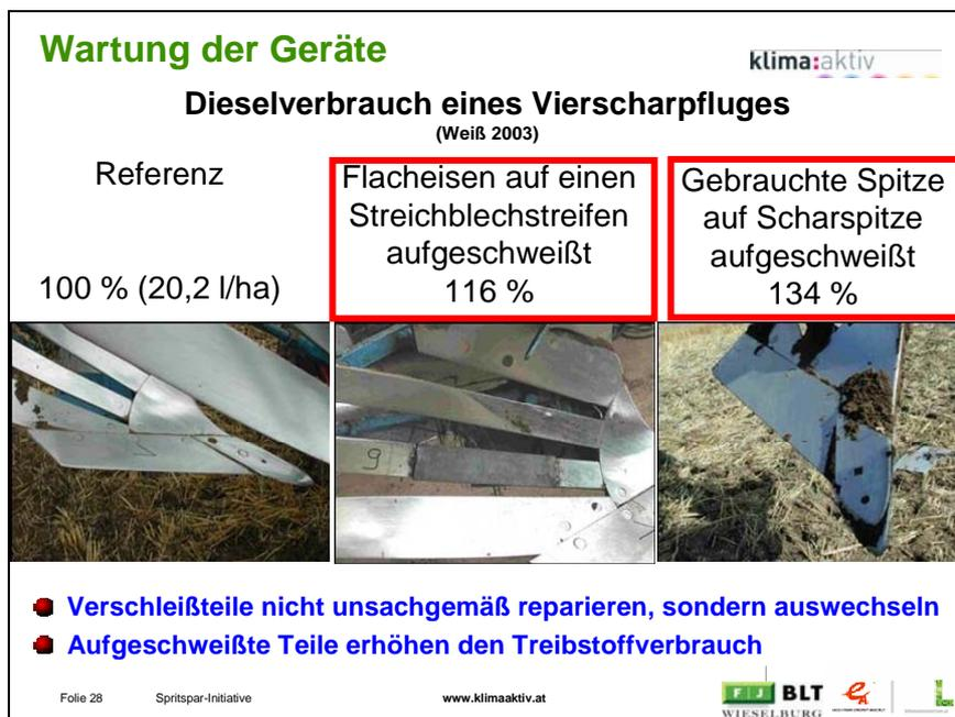
Abbildung 24: Dieserverbrauch eines Vierscharpfluges bei ausgebesserten Verschleißteilen im Vergleich zu einem unveränderten Originalpflugkörper [WEIß 2003]
