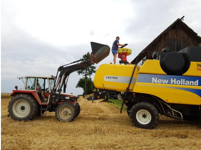
Befüllen des Feinsamenstreuers mit Begrünungssaatgut
