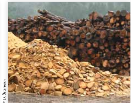
Beim Einschnitt von Sägerundholz fallen neben dem Hauptprodukt Schnittholz auch große Mengen an Sägenebenprodukten, wie Hackgut, Späne, Kappholz und Rinde, an.
